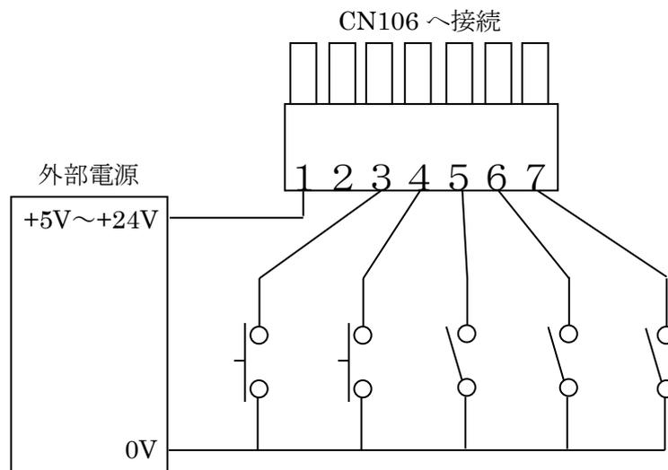
フォトカプラ駆動用に外部電源（+5V~+24V）を別途ご準備いただき、CN106に接続する付属コネクタの1番ピンに+電源を、3~7番ピンを外部電源の0Vに接続することでフォトカプラがONします。3~7番ピンと0Vの間にスイッチを入れることで、外部からの操作が可能となります。
